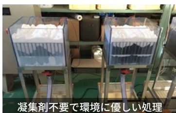
テスト分離の様子 (水溶性廃液ニス)
